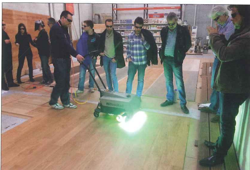
VITRIFICATION - Cette technique de vitrification à réticuler est réalisée à l'aide d'une machine à UV portable.
